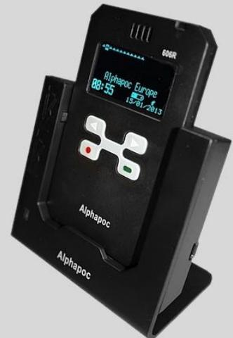
Der Meldeempfänger 606R gehört zu der Profiklasse unserer digitalen Meldeempfänger und zeichnet sich besonders durch sein kleines und flaches Format aus. Er ist sehr robust und wasserdicht.
